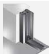
A: Telepítés a kapunyílásba
